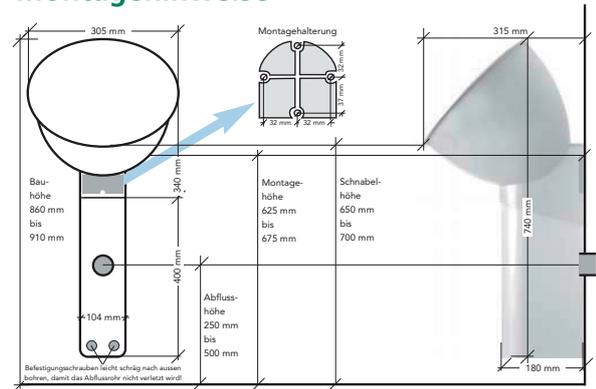
Die angegebenen Anschlussmaße beziehen sich auf bauseits vorbereitete wandbündige Steckmuffe DN 50 mit Lippendichtung.
