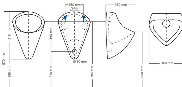
Die angegebenen Anschlussmaße beziehen sich auf bauseits vorbereitete, wandbündige Steckmuffe DN 50 mit Lippendichtung. Anschluss am Entwässerungssystem nur mit Keramikanschlussstutzen und Gummimanschette (sind im Lieferumfang enthalten).
