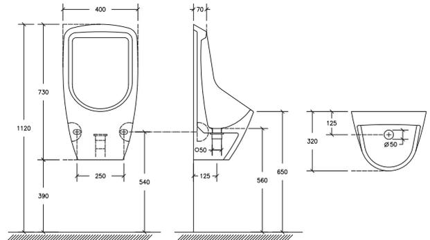
Die angegebenen Anschlussmaße beziehen sich auf bauseits vorbereitete, wandbündige Steckmuffe DN50 mit Lippendichtung. Anschluss am Entwässerungssystem nur mit Keramikanschlussstutzen, z.B. V&B Art. Nr. 99820000 oder Marley Art. Nr. 093048 (nicht im Lieferumfang enthalten!).
