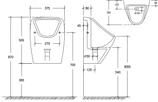
Die angegebenen Anschlussmaße beziehen sich auf bauseits vorbereitete, wandbündige Steckmuffe DN 50 mit Lippendichtung. Anschluss am Entwässerungssystem nur mit Keramikanschlussstutzen und Gummimanschette (sind im Lieferumfang enthalten).
